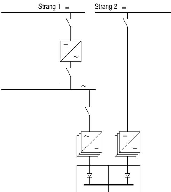
**Bild 4-3:** Beispiel eines Konzeptes mit redundanten Schaltungsteilkombinationen zur Versorgung von leitentechnischen Einrichtungen
